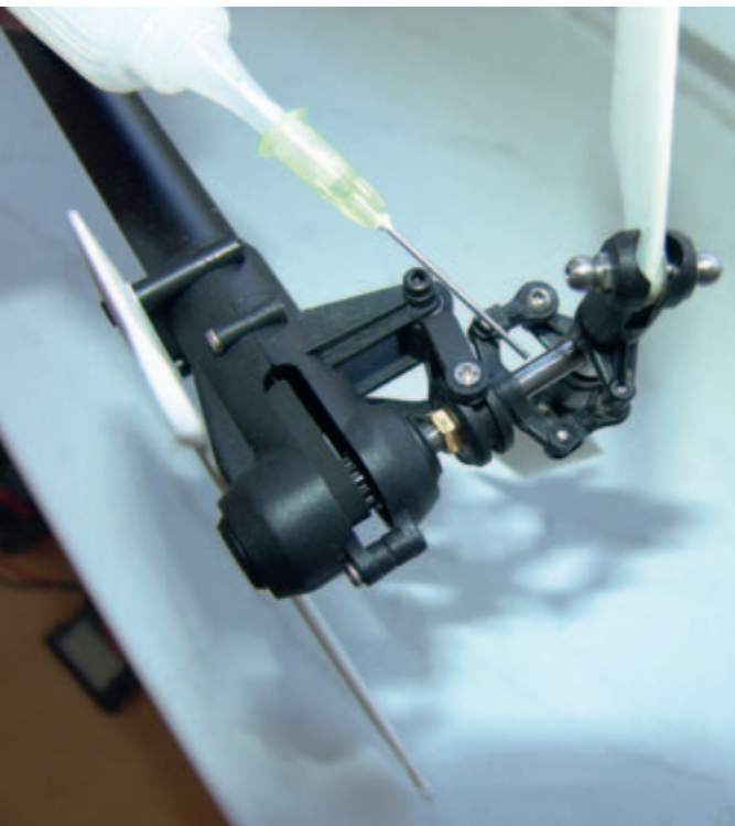
Bevor man DryFluid aufträgt, sollten die entsprechenden Bauteile gründlich gereinigt werden. Hier die Pitch-Schiebehülse eines Blade 450-Heckrotors
