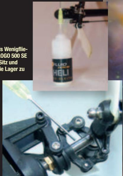
Beim Check sollte auch die Heckrotor-Schiebehülse nicht vergessen werden. Hier bietet sich dünnflüssiges, fein dosierbares Spezialöl an, nachdem die Bauteile sorgfältig gesäubert wurden
